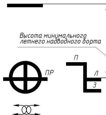
Рис. 3.1.4-2. Грузовая марка судов с минимальным надводным бортом
